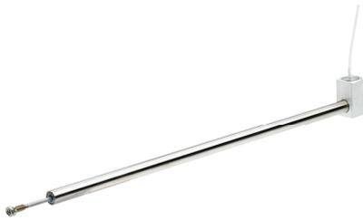
Induktiver Wegaufnehmer in Halbbrückenschaltung, in  $\varnothing 12$  mm Gehäuse mit Sonderflansch, kalibriert auf 80 mV/V Nennsignal, erhöhte Impedanz, insb. geeignet zum Einbau in Prüfzylinder
